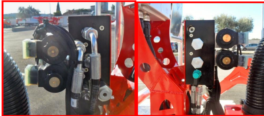
Afbeelding 55: weergave zijde machine links/rechts van het knoppenpaneel voor nivellering en rotatie.
