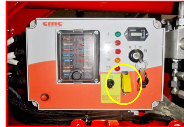
Afbeelding 52: toets bypass noodstop.
