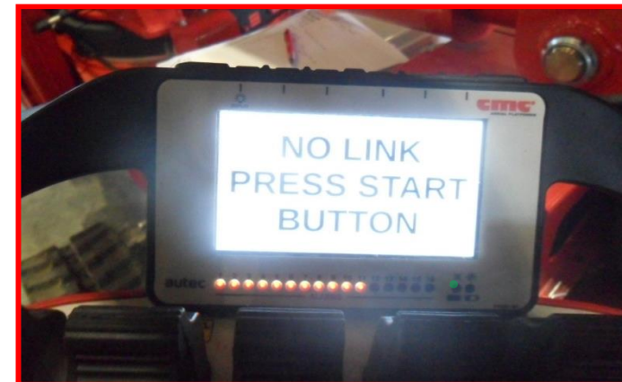
Afbeelding 15: signalering niet-gekoppelde afstandsbediening.
