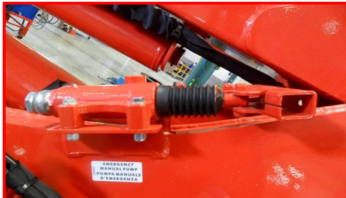
Afbeelding 60: inbrengpunt van de handpomp.
