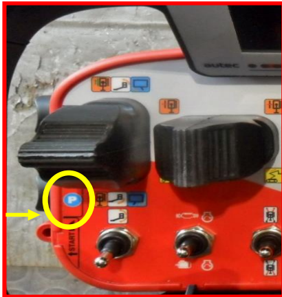
Afbeelding 51: knop P voor bypass botsbeveiligingssysteem.
