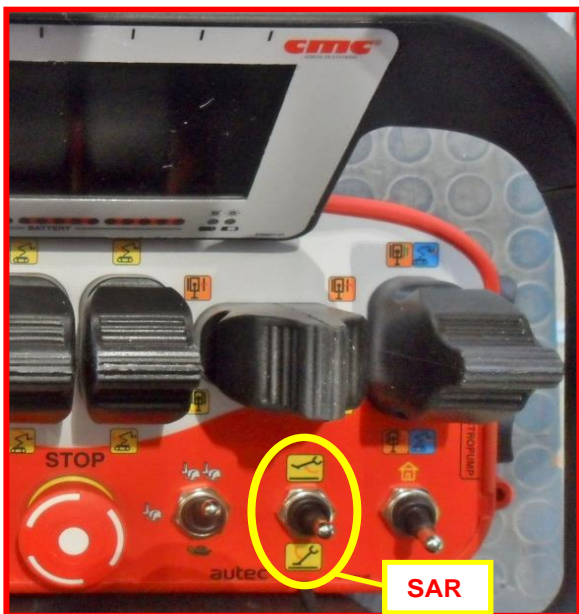
Afbeelding 48: keuzeschakelaar automatische stabilisatie/destabilisatie op de afstandsbediening.
