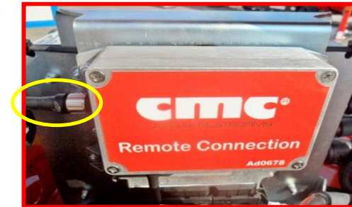
Afbeelding 114: kastje voor verbinding op afstand.
