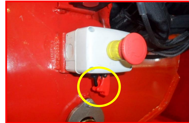
Afbeelding 45: toets voor bypass verplaatsingsblokkering.
